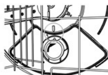
Στρέψτε δεξιόστροφα το φίλτρο αποστράγγισης μέχρι να ευθυγραμμιστούν τα βέλη (βλ. εικόνα)
